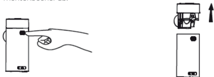
Abbildung 6 Abnehmen des Medikamentenbechers
